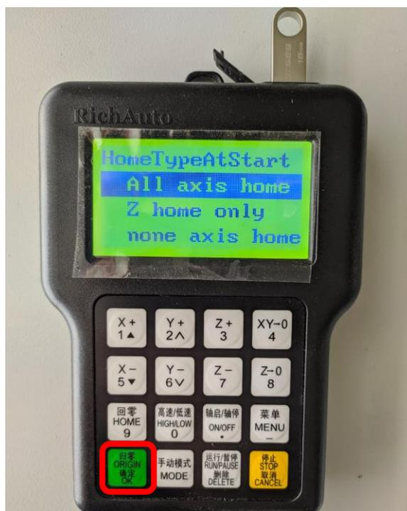
Presione las teclas X+, X-, Y+, Y-, Z+, Z-, para hallar el punto 0 u origen de la pieza a cortar.
