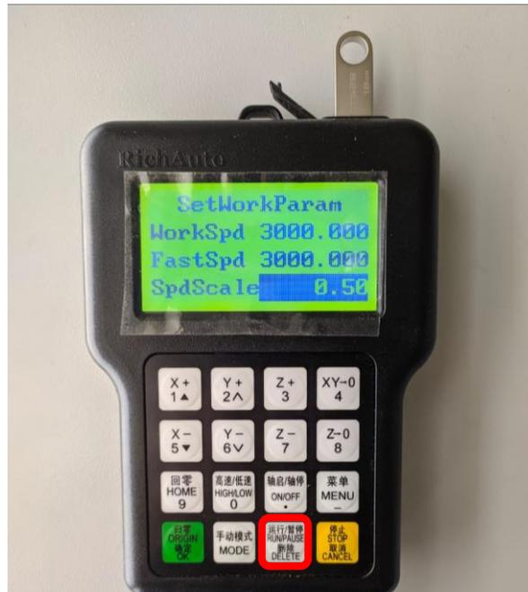
Presionar la tecla OK para iniciar el corte, y seguidamente la tecla “Run/Pause” para pausar la perforación hasta que en el panel de control registre 2700rpm, una vez se alcance esta velocidad, presionar nuevamente “Run/Pause”.
