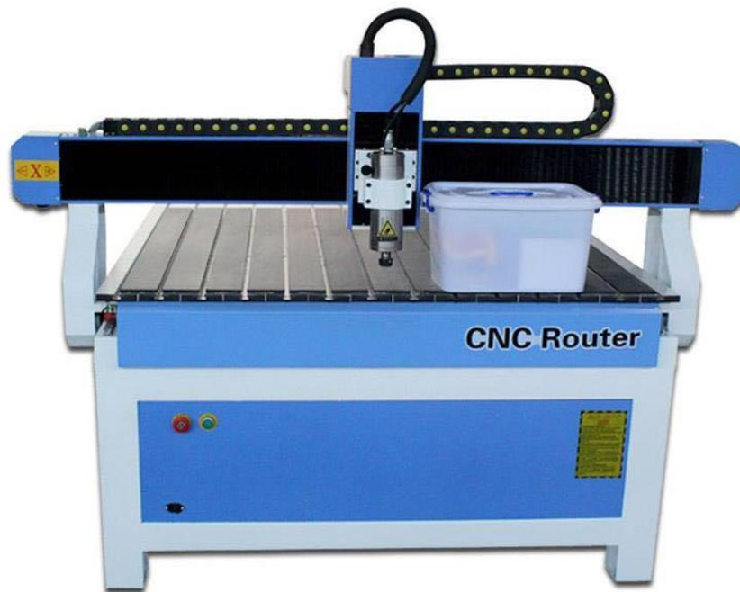
Antes de encender la máquina, asegúrese que la bomba esté completamente sumergida en agua, ya que es el mecanismo de refrigeración de esta; de lo contrario estaría en riesgo inminente de quemado.
