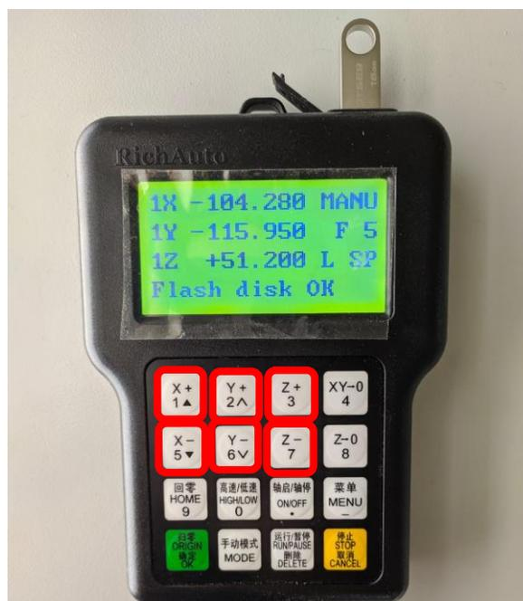
Algunos centímetros (aproximadamente 3cm) antes de que la broca esté cerca de la pieza, se recomienda presionar la tecla “Mode” para cambiar el modo de desplazamiento de “Continue” a “Step” y presionar la tecla Z- para desplazar lentamente el husillo (brazo) de la máquina, evitando averías por presión.
