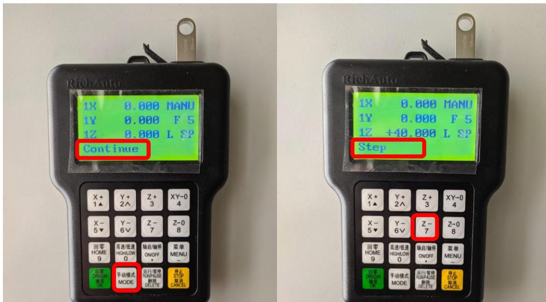
Presionamos las teclas XY-0 y Z-0 para marcar el punto de “origen en la pieza”
